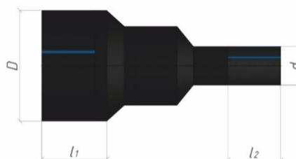
Общий вид сварного перехода  $D \times d$  с удлинениями  $l_1$  и  $l_2$  мм
