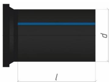
Общий вид сварной втулки номинальным диаметром  $d$  с удлинением  $l$  мм
